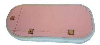
El proceso de fabricación de la estructura interna del respaldo, por su diseño original, está compuesto por hojas de madera triplay 12mm de alta calidad, debido a que es un material de no tan alta densidad lo que permite un fácil manejo y versatilidad de su uso.
